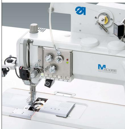
Elektronisch geregelte Fadenspannung (ETT mit Fadenkraftsensor) für programmierbare Oberfadenspannungen. Unterfadeneidentifikation durch Erfassung des jeweiligen Barcodes
