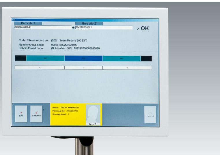
Datenerfassung, Datenüberwachung und Datenspeicherung durch networkfähigen Touch-Panel PC mit grafischer Nahtprogrammdarstellung und einfacher Nähprozessführung
