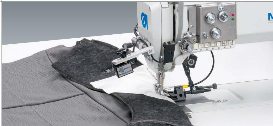
Sichere Erfassung des Sollreißnahtbereiches durch Glasfaseroptik
