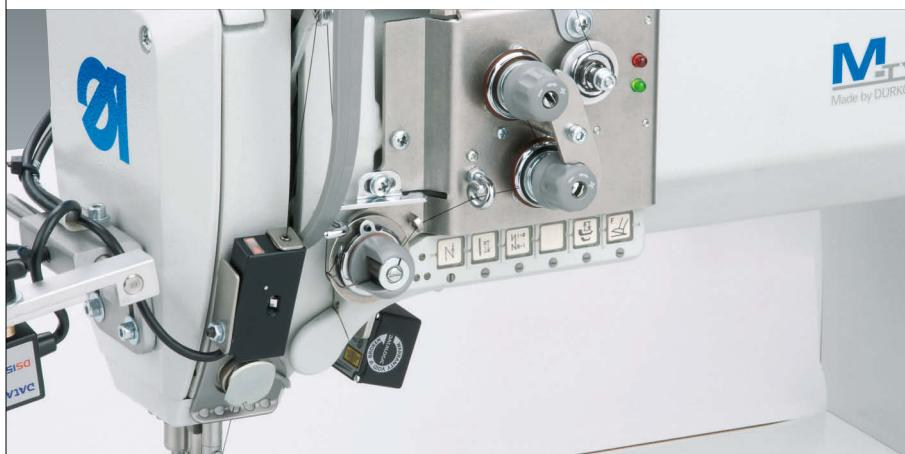
Mechanisch justierbare Fadenspannung (MTT mit Fadenkraftsensor und fixierbarem Stellelement)
