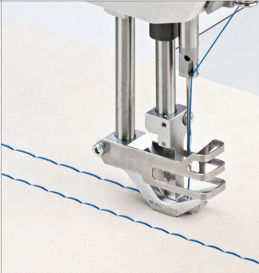
Die Transportkinematik in Kombination mit dem XL-Barellgreifer ermöglicht die Verarbeitung extremer Nähgarnstärken – und das bis zu einer maximalen Stichelänge von 15 mm.
