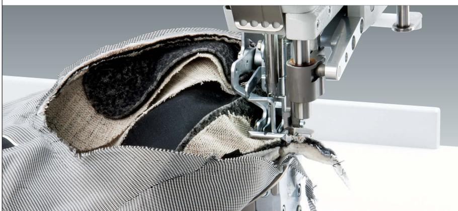
**Die integrierte LED Nähleuchte** ist standardmäßig im Oberteil eingebaut. Sie bietet eine perfekte Ausleuchtung der Nähstelle.
