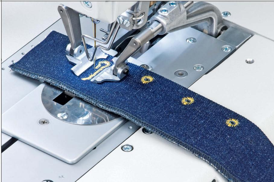
**MULTIFLEX Anwendung – Nähen und Schneiden von zwei unterschiedlichen Formen:**
