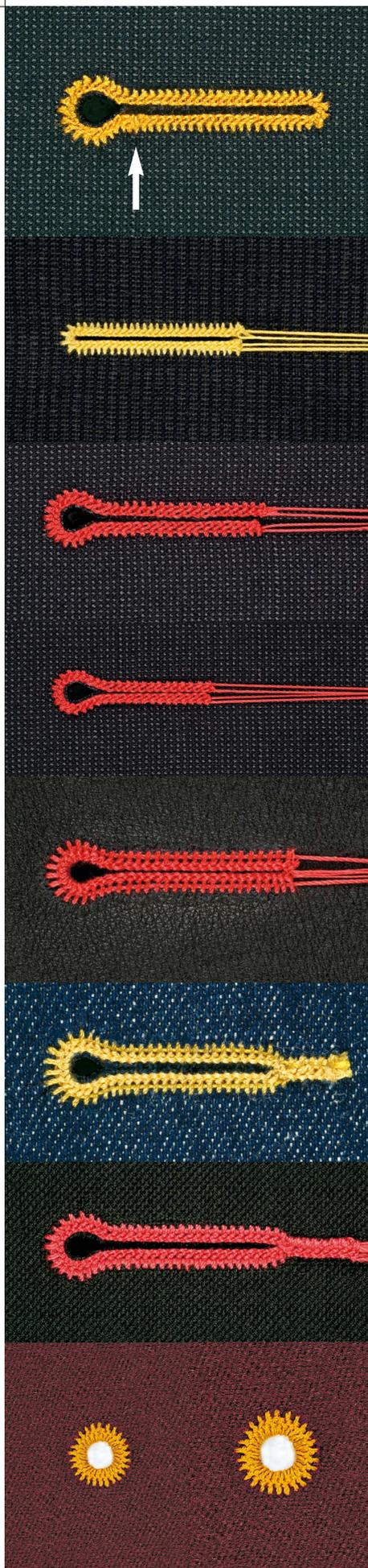
**581-112 E1151:** Augenknopfloch mit Rundriegel, bis max. 5 mm Breite; Schneidvorgang nach dem Nähen; ohne Gimpe; wählbarer Nähbeginn: Nähbeginn und Nähende liegen kurz unterhalb des Auges – der Rundriegel ist perfekt sauber; typische Anwendungen: Hinterhosentaschen und Ärmelschlitz.
